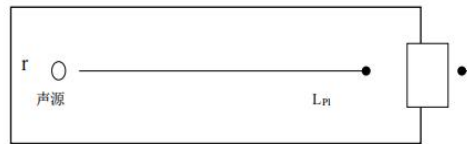
图 4-2 室内声源等效为室外声源图例
